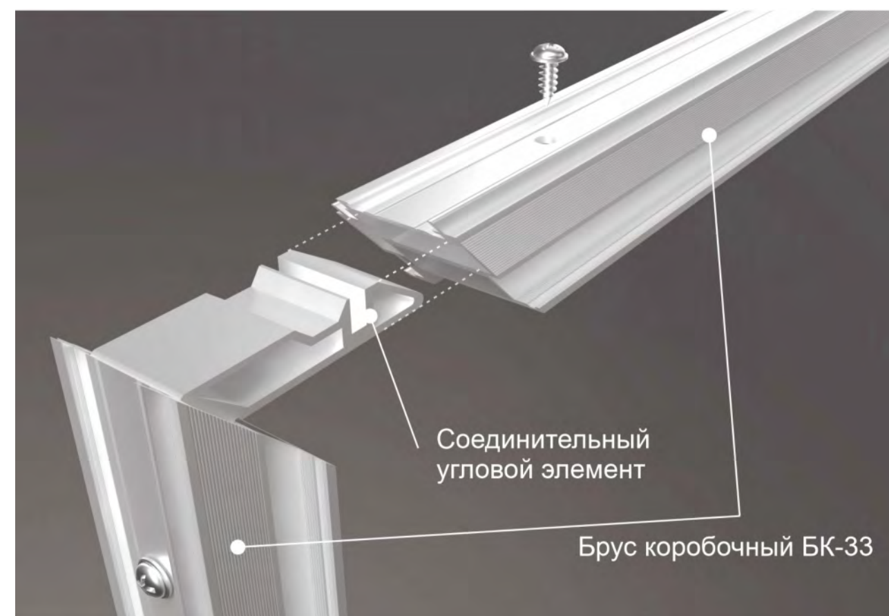
Схема фиксации угловых соединений в бруске коробочном БК-33
